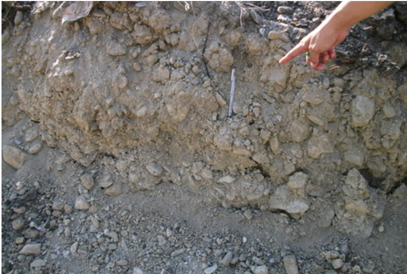
Gambar 3. Singkapan endapan material rombakan yang bersifat lepas di Jalan Soekarno Hatta, Kota Palu.
