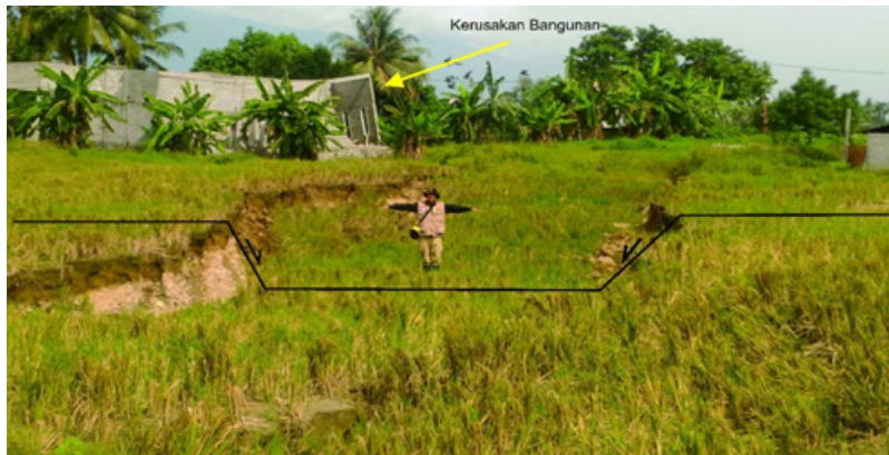
Gambar 11. Bentukon tinggi dan rendahan akibat lateral spreading di dekat bagian mahkota
