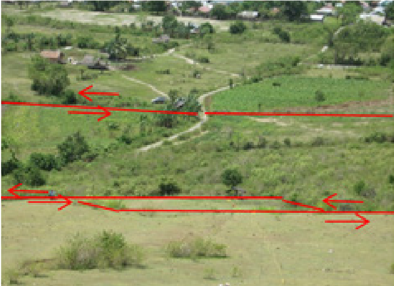
Gambar 3: Offsett pada permukaan aluvium
