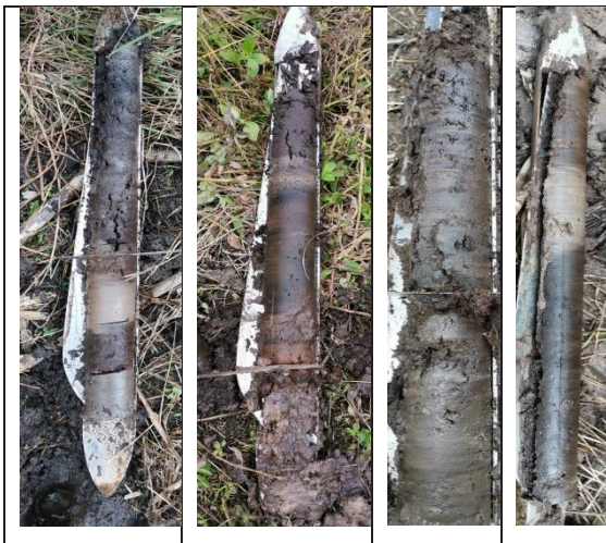
Gambar 4. Kenampakan gambut dengan sisipan lempung – lanau.
