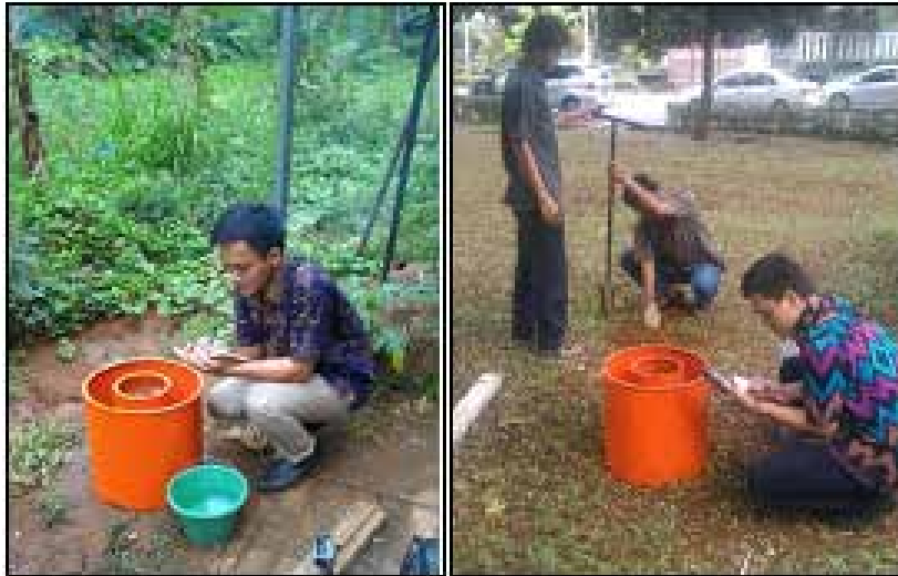
Foto Uji infiltrasi pada kegiatan Penyelidikan Imbuhan Air Tanah Pada Akuifer tidak Tertekan CAT Jakarta
