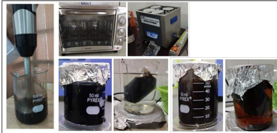
Gambar 15. Teknik ultrasonikasi berulang dan proses dialysis
