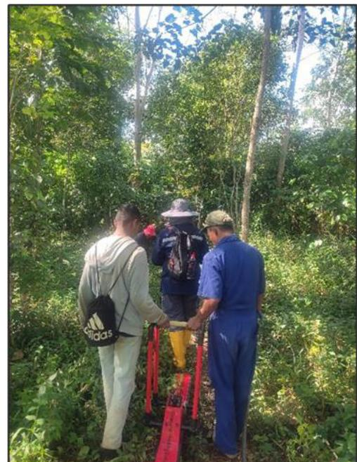
**Gambar 2.** Peralatan GPR yang digunakan dalam kegiatan prospeksi
