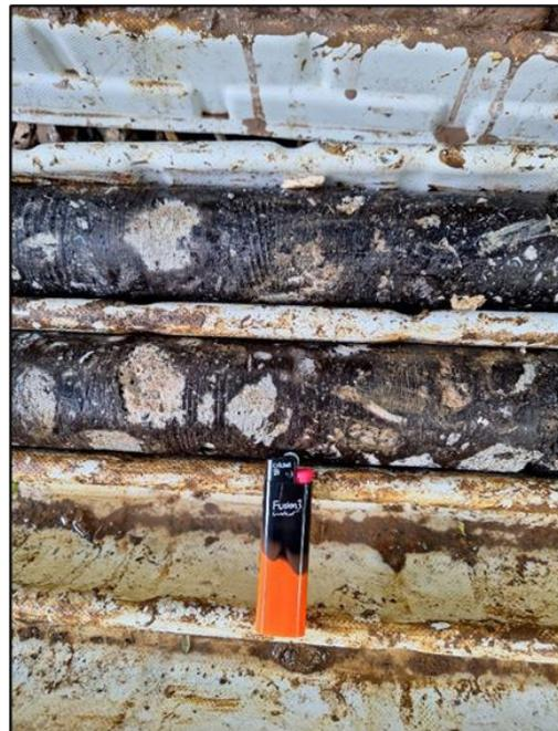
**Gambar 5.** Hasil coring aspal di titik BHD02
