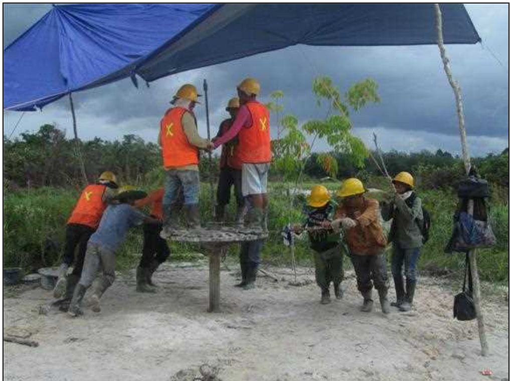
Gambar 4. Pengambilan conto bor menggunakan bor Bangka 4 inci
