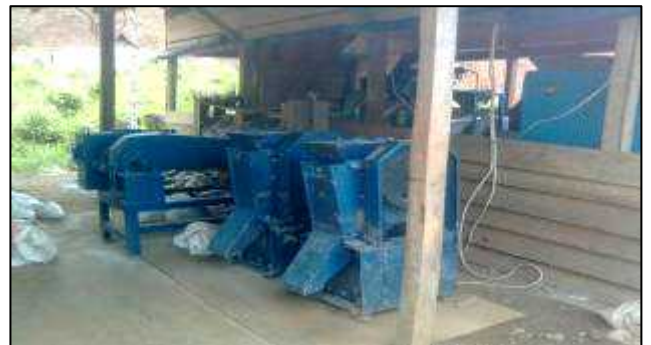
Gambar 11. Alat Pemecah Batu (Crusher) Biji Besi pada PT. Harita Persada Jaya
