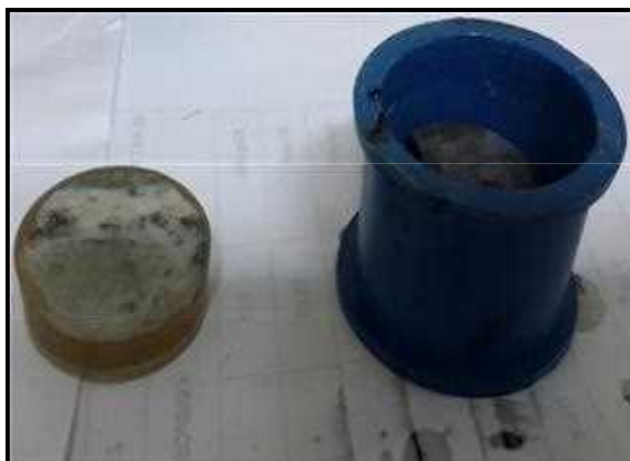
Blok yang sudah kering dikeluarkan dari cetakan
