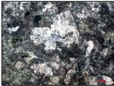
Foto 1. Fotomikrograf Andesit amigdaloidal (HSTB 03 R) disusun oleh fenokris plagioklas, didalam masa dasar butiran – butiran halus plagioklas, mineral opak dan sedikit piroksen. Tampak klorit mengisi rongga-rongga (amigdaloidal) yang dikelilingi oleh oksida besi.
