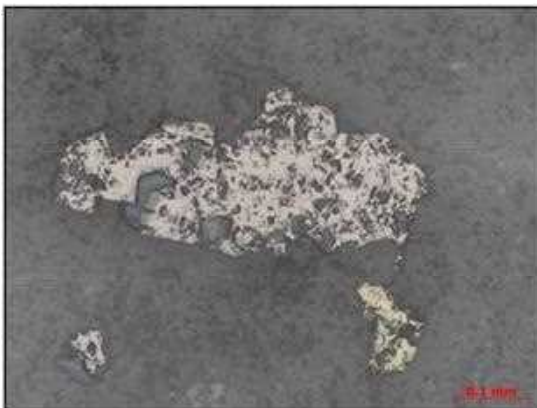
Gambar 6a. Fotomikrograf sayatan poles pirit dan kalkopirit yang nampak tersebar dalam massa silikat Conto RK14-19F
