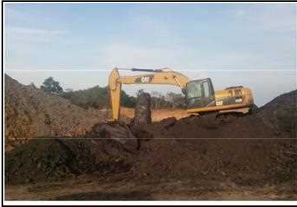
Gambar 7 Sistem penambangan bijih besi menggunakan alat dozer atau bucket excavator
