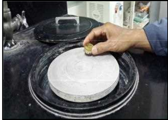
Pemolesan blok dengan mesin poles dengan polishing alumina yang dicampur air
