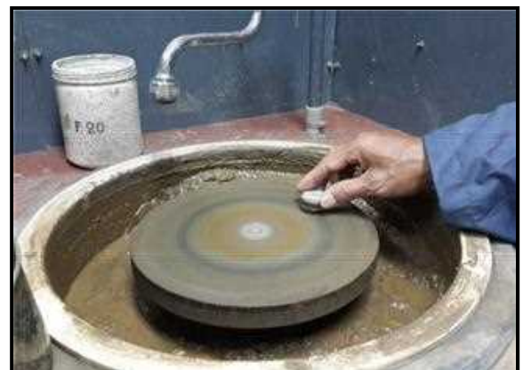
Pengasahan blok dengan piringan putar (Gerinda)
