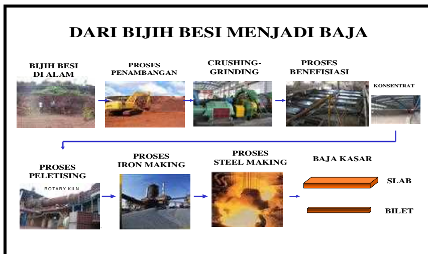
Gambar 16. Tahapan proses pembuatan baja (Sobandi, 2005)
