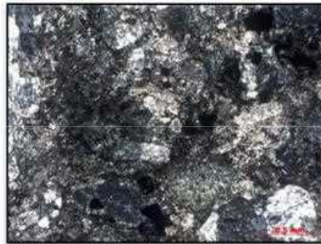
Foto 1. Fotomikrograf Andesit amigdaloidal (HSTB 03 R) disusun oleh fenokris plagioklas, didalam masa dasar butiran – butiran halus plagioklas, mineral opak dan sedikit piroksen. Tampak klorit mengisi rongga-rongga (amigdaloidal) yang dikelilingi oleh oksida besi.
