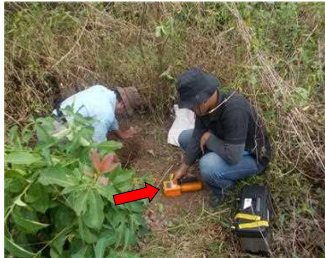
Gambar 2. Pengukuran deteksi Unsur Tanah Jarang (UTJ) dengan alat Geofisika Radiometri, Gamma Surveyor II di daerah Dusun Air Bergantung
