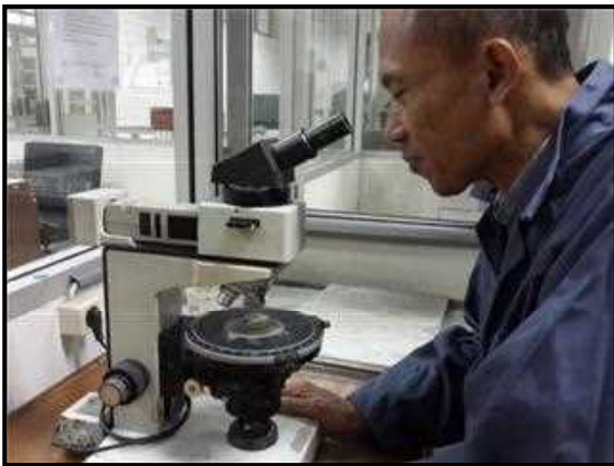
Pengecekan di bawah mikroskop untuk mengetahui apakah sayatan poles sudah rata, mengkilat, dengan jumlah goresan, retak atau cacat lainnya minimum. Jika masih banyak goresan, dipoles kembali.
