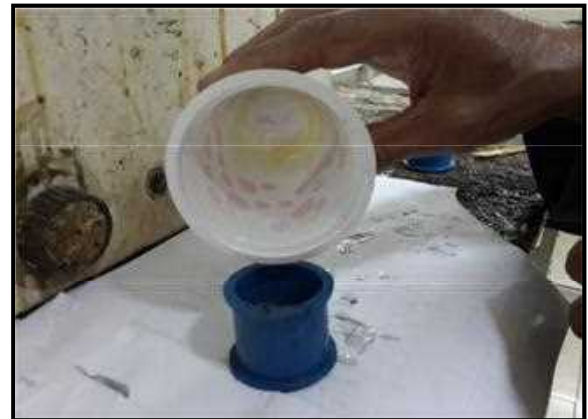
Cuplikan ditempatkan pada cetakan dan dituangi campuran resin
