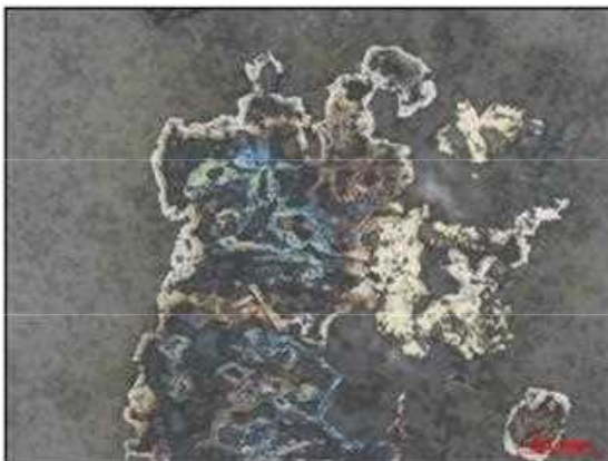
Gambar 6a. Fotomikrograf sayatan poles pirit dan kalkopirit yang nampak tersebar dalam massa silikat Conto RK14-19F
