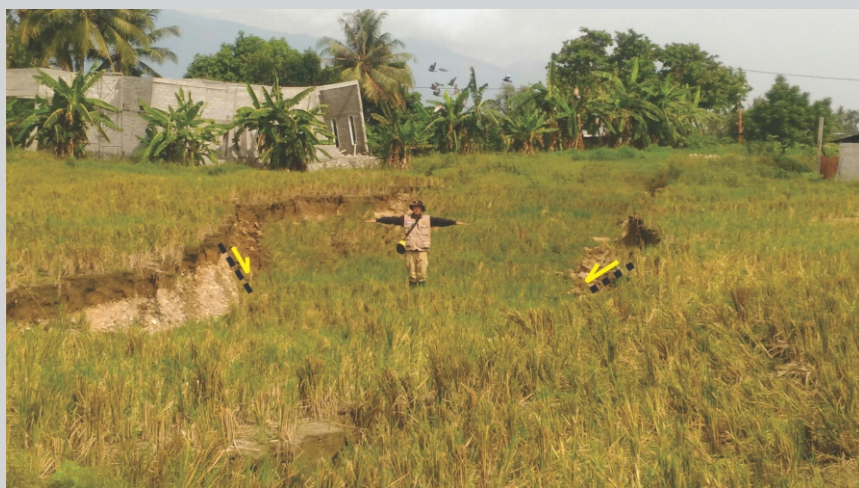
Contoh penurunan permukaan tanah di daerah Lolu - Jonooge akibat gempa Palu 28 September 2018
