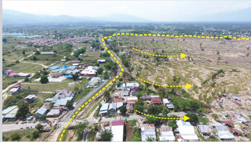
Contoh tipe likuefaksi aliran yang menyebabkan longsoran di Petobo akibat gempa Palu 28 September 2018
