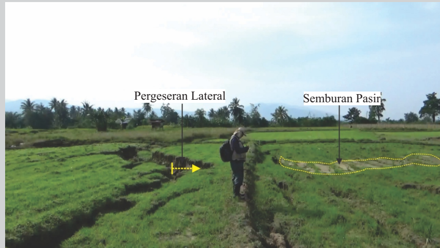
Contoh pergeseran lateral di tanah permukaan di daerah Lolu - Jonooge akibat gempa Palu 28 September 2018
