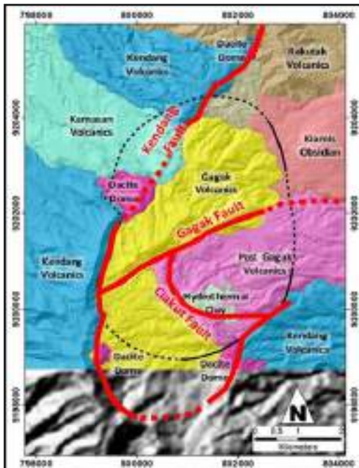
Gambar 5.7. Peta geologi permukaan Lapangan Darajat menunjukkan interpretasi struktur berdasarkan data LIDAR dan offset batuan reservoir. Baik struktur Kendang maupun Gagak menonjol di permukaan sementara Ciakut terkubur; struktur putus-putus di mana disimpulkan. Data LIDAR hanya mencakup bagian peta yang berwarna. Warna sesuai dengan batuan bawah permukaan pada Gambar 41. Poligon hitam mewakili batas produksi; putus-putus ketika tidak dibatasi dengan data sumur. (Sumber: Rindu Grahabhakti Intani, drr., 2020).
