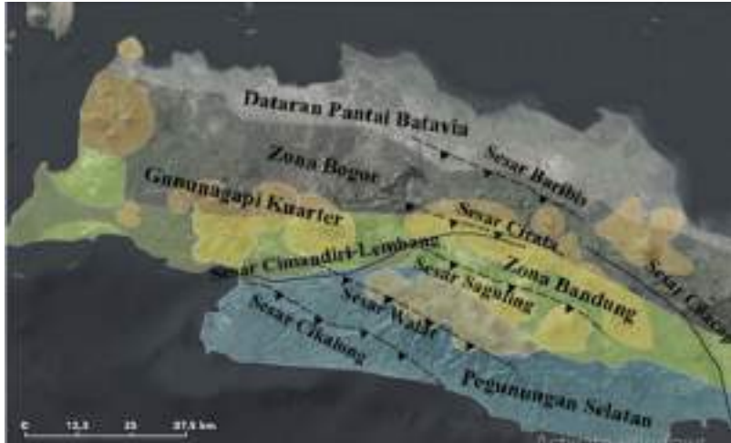
Gambar 1.8. Pola umum struktur geologi daerah Jawa bagian barat. Warna menunjukkan zona fisiografi yaitu zona Dataran Pantai Batavia, zona Bogor, zona Bandung dan zona Pegunungan Selatan serta struktur geologi regional yang terbentuk, (Permana, 2015).
