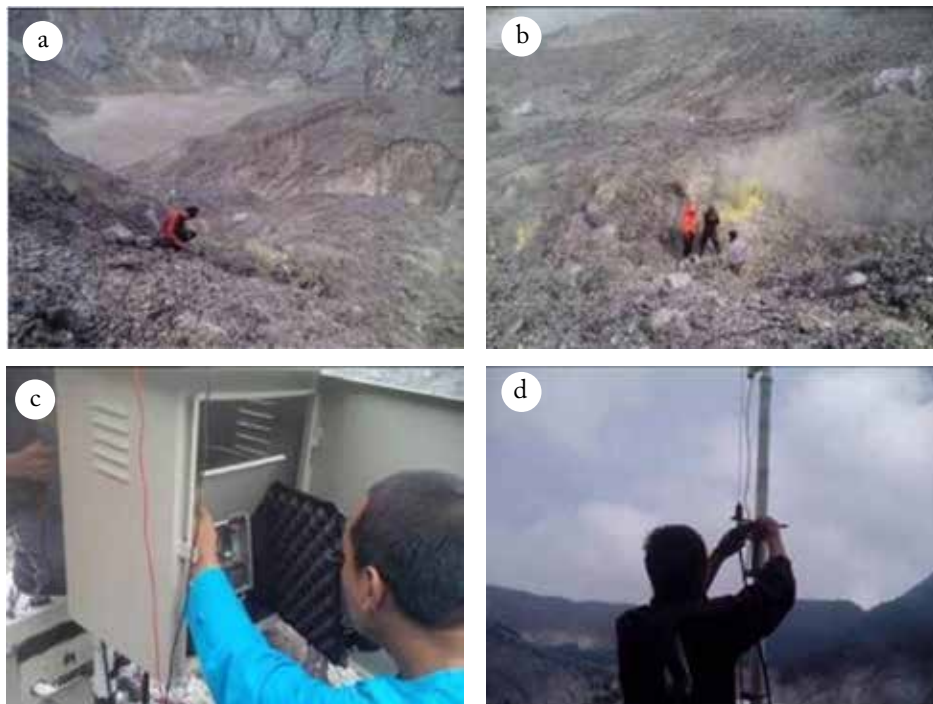
Gambar 4.177 Instalasi sensor, sistem akuisisi data dan sistem transmisi. a. Instalasi sensor 1A dan 1B. b. Instalasi sensor 2A dan 2B, tampak warna kuning yang menandakan aktivitas sulfatara. c. Instalasi modul akuisisi data TLR di boks panel. d. Instalasi antenna larsen di tiang.
