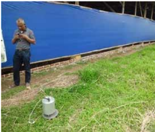
Gambar 4.155 Pengukuran mikrotremor di Desa cikubangsari, Kec. Kramat mulya, Kab. Kuningan, Jawa Barat.
