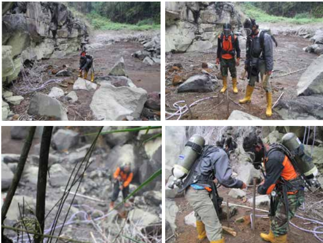
Gambar 4.180 Pembuatan lobang penempatan sensor suhu tanah. Petugas membuat lobang dengan berbagai cara karena harus menembus tanah bebatuan di permukaan Kawah Timbang.
