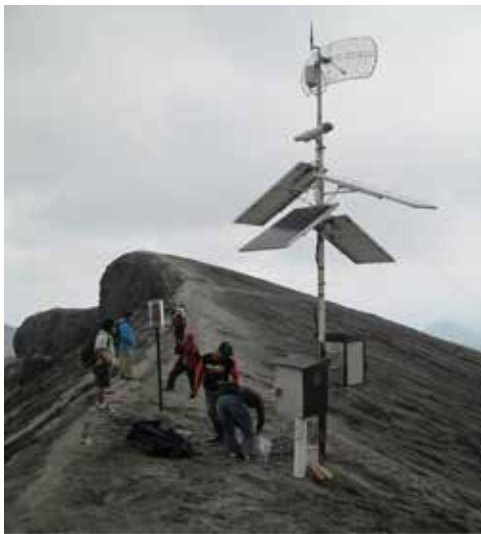
Gambar 4.188 Stasiun multiparameter yang dipasang di Bukit Lirang, G. Kelut. Pada tiang teramati (dari atas) penangkal petir, antenna, kamera, solar panel, kotak rumah system telemetri dan kotak rumah system power yang kedudukannya diperkuat dengan penyangga pipa pralon yang diisi semen beton.
