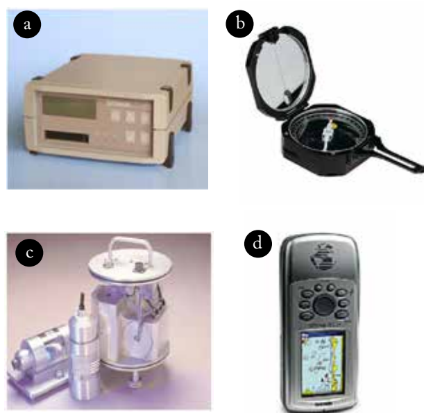
Gambar 4.220 (a) Data logger LS-700, (b) Kompas, (c) Seismometer 1,0 Hz 3 komponen, (d) Handy GPS Gemini.
