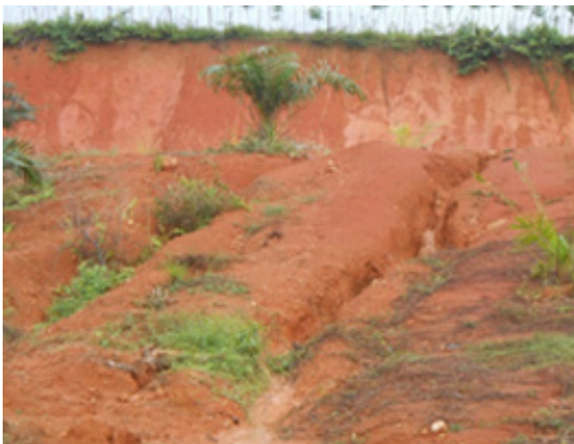
Kenampakkan erosi dengan kedalaman 60 – 100 cm pada tanah pelapukan Formasi Idi (Qpi) di Desa Bugeng, kec. Peudada.
