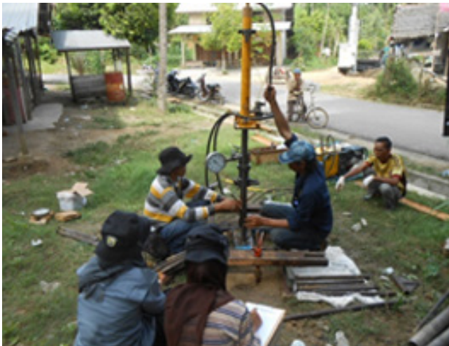
Kegiatan penyondiran pada daerah yang dibentuk lempung lanauan pada Formasi Idi (Qpi), di Desa Bukit dalam, Kec.Kuta Blang.
