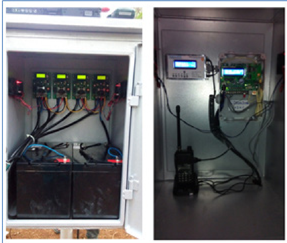
Gambar 3.5. Sistem catu daya dan sistem transmisi data pada stasiun repeter
