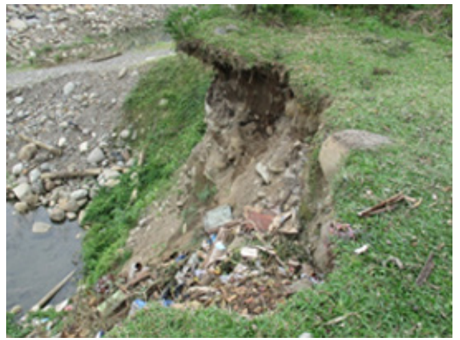
Kenampakkan erosi dengan kedalaman 60 – 100 cm pada tanah pelapukan Formasi Idi (Qpi) di Desa Bugeng, kec. Peudada.
