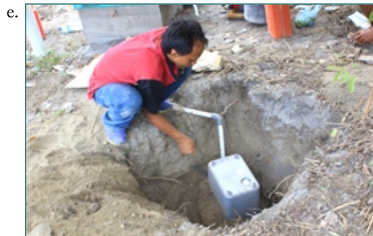
Gambar Proses instalasi tiltmeter dan sistem akuisisi data TLR di stasiun Suri. a. Instalasi tiltmeter dalam lubang untuk menghindari pengaruh suhu luar. b. Solar panel untuk mencatu 2 unit aki sebagai system catu daya lapangan. C dan d proses instalasi sistem akuisisi data TLR. e. Tiltmeter yang telah diinstal ditutup termos lalu dikubur dengan tanah. f. Hasil kalibrasi tiltmeter. Kanan komponen X, kiri komponen Y.
