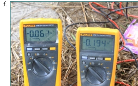
Gambar Proses instalasi tiltmeter dan sistem akuisisi data TLR di stasiun Suri. a. Instalasi tiltmeter dalam lubang untuk menghindari pengaruh suhu luar. b. Solar panel untuk mencatu 2 unit aki sebagai system catu daya lapangan. C dan d proses instalasi sistem akuisisi data TLR. e. Tiltmeter yang telah diinstal ditutup termos lalu dikubur dengan tanah. f. Hasil kalibrasi tiltmeter. Kanan komponen X, kiri komponen Y.
