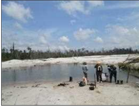
Gambar 3. Endapan tailing dan kolam bekas penambangan PETI di daerah Sungai Tengkorak, Mandor
