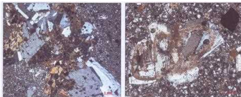
Gambar 4. Fotomikrograf sayatan tipis andesit tampak plagioklas dan hornblende terubah ke karbonat.
