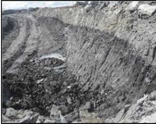
Gambar 3. Lapisan serpih bitumen diantara lapisan batubara di lokasi penambangan PT Bima Gema Permata.
