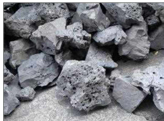
Gambar 6. Slag tailing pengolahan smelter mengandung UTJ yang tinggi
