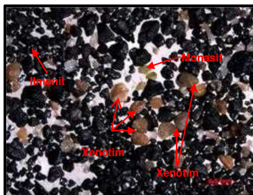
Foto 5. Fotokimrografi Kode Contoh AN 034 P. Butiran mineral Ilmenit, hitam, kilap metalik, bentuk menyudut tanggung, Xenotim, coklat, kilap lilin, Monasit, kuning kehijauan, kilap lilin.
