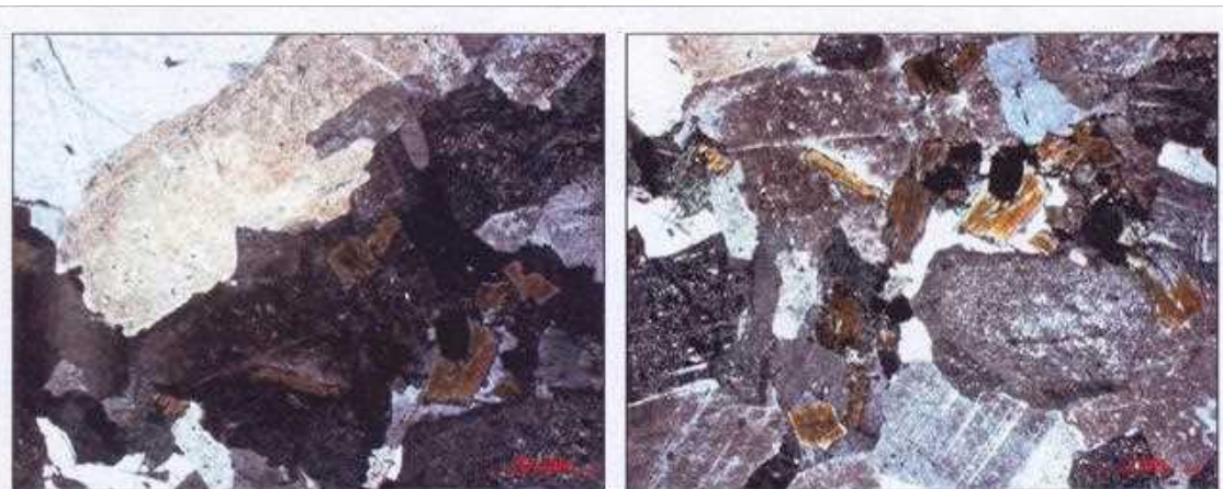
Gambar 2. Fotomikrograf sayatan tipis granit, tampak ortoklas berubah ke mineral lempung dan plagioklas berubah ke serisit, sedangkan biotit ke klorit dan mineral opak.
