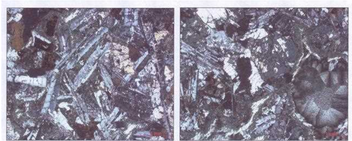
Gambar 3. Fotomikrograf sayatan tipis diabas, tampak plagioklas sedikit berubah ke klorit-serisit.
