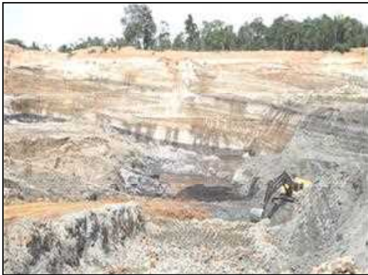
Gambar 4. Foto endapan bitumen yang ikut terbuang pada saat kegiatan penambangan batubara. Lokasi PT. Rudy Jaya Mandiri
