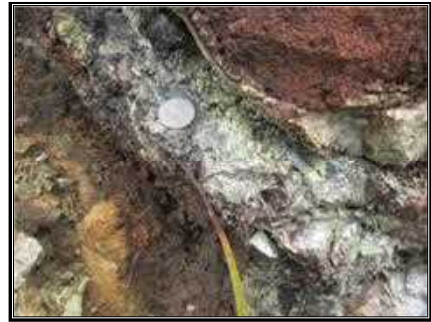
Gambar 6. Foto serpentinisasi di bidang rekahan pada batuan peridotit yang telah menunjukkan struktur asbestos pada koordinat 283.626 mE – 9.692.584 mN
