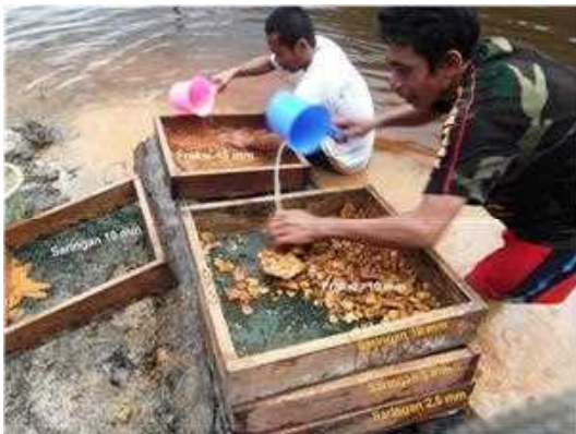
Gambar 3. Foto proses pencucian bauksit menggunakan saringan bukaan 10 mm dan 5 mm dengan cara disusun dari atas ke bawah dari besar – kecil
