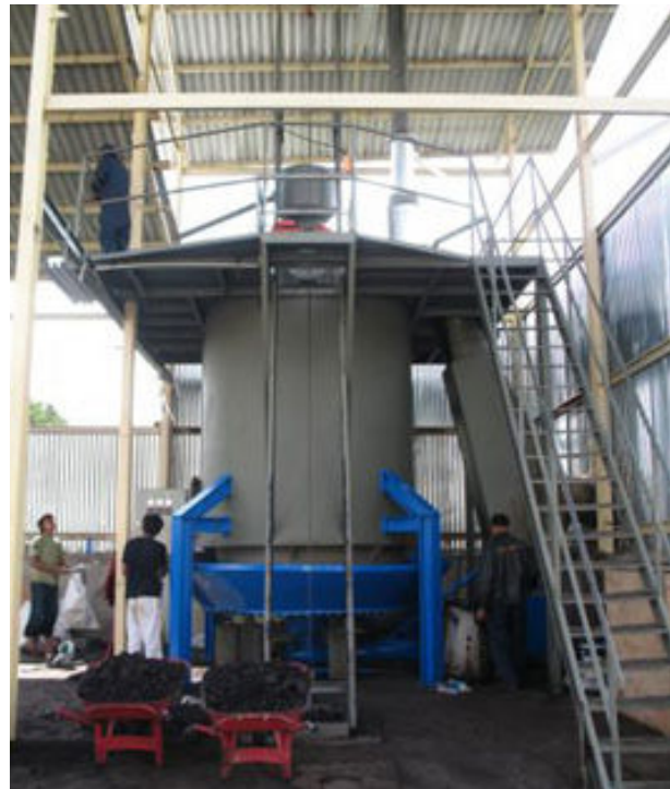
Reaktor gasifikasi batubara di pabrik tekstil, Banjaran, Bandung, Jawa Barat. ( http://gorgeous.indonetwork.co.id/ )
